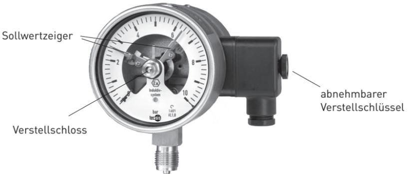
Die Sollwertzeiger der Grenzwertschalter sind im gesamten Skalenbereich frei einstellbar. Aus Gründen der Schaltgenauigkeit und der Lebensdauer der mechanischen Messsysteme sollen die Schaltpunkte zwischen 10 % und 90 % der Messspanne liegen.
